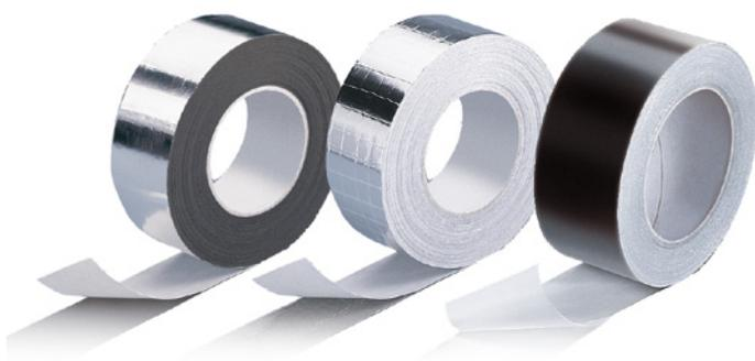
Лента алюминиевая самоклеящаяся AA 130 изготавливается из алюминиевой фольги с акриловым клеевым слоем постоянной липкости и предназначена для склейки швов изделий с покрытиями ALU, METAL, IC CLAD SR. Лента AR 107 дополнительно армируется сеткой.
