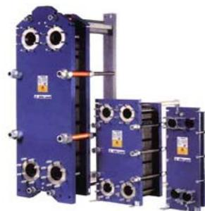
Пластинчатые теплообменники Alfa Laval значительно компактнее и, соответственно, легче кожухотрубчатых теплообменников при одинаковой мощности; надежны, просты в установке и не требуют специального фундамента; не требуют больших затрат на обслуживание и ремонт при периодической очистке поверхности пластин; в **разборных теплообменниках** предусмотрена возможность изменения тепловой нагрузки – для этого нужно лишь добавить или убрать необходимое количество пластин.
